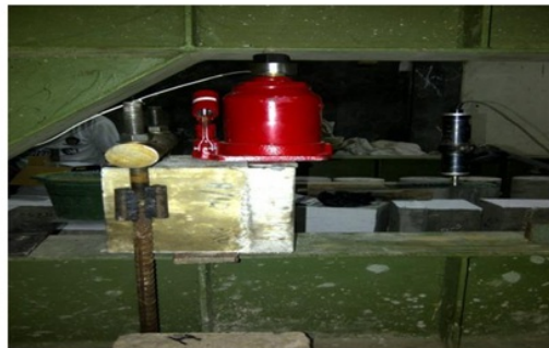
Gambar 24. Pengujian Kuat Geser Interface dengan Metode Modified Bi-surface Shear Test
